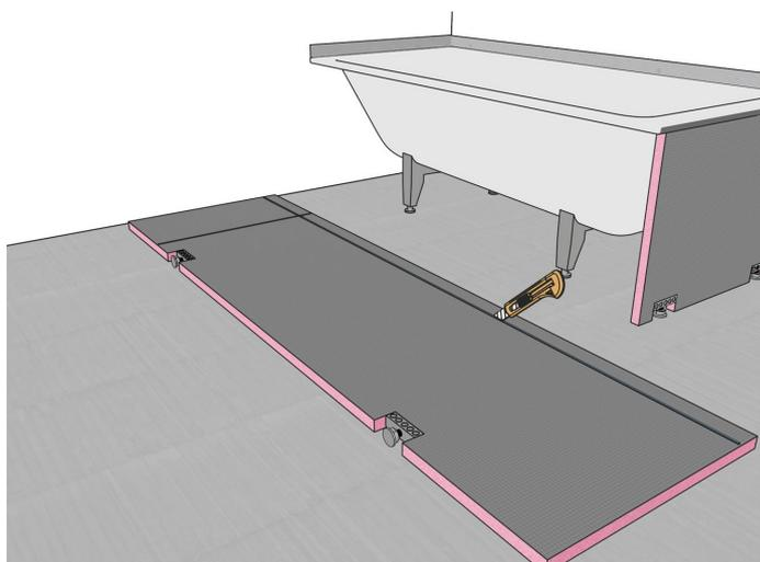
2) Il est conseillé de réaliser deux découpes servant de poignée dans le bord supérieur du panneau afin d'en faciliter sa manipulation lors de la pose.
