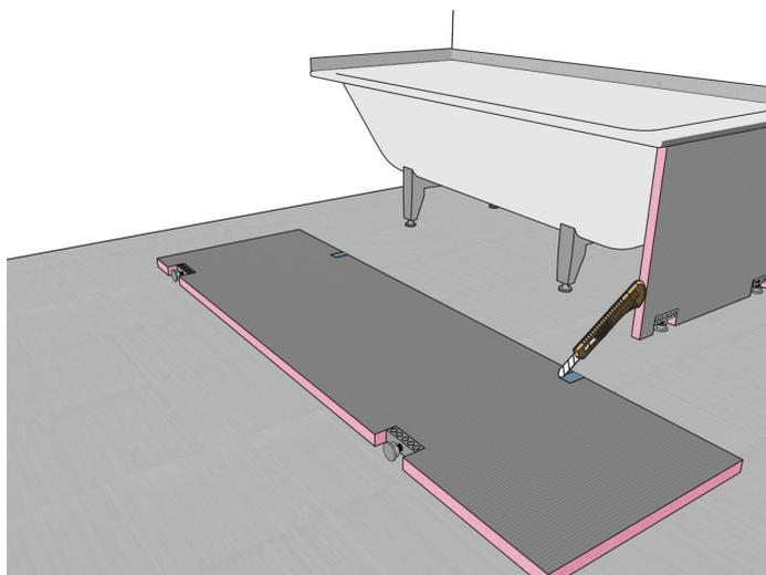
3) Poser un cordon de colle / mastic d'étanchéité BOARD-FIX®, sur le chant horizontal supérieur et celui vertical côté mur ainsi que sur le chant du panneau préalablement posé servant d'appui.
