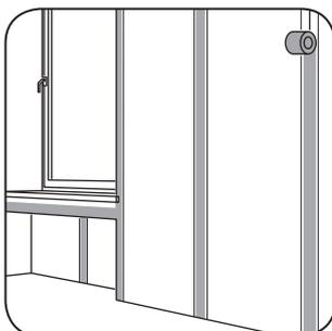
Les jonctions doivent être traitées à l'aide d'une bande d'armature (par exemple bande à joints papier) et d'un enduit (par exemple enduit prêt à l'emploi à joints) en deux passes. Dans les zones soumises à beaucoup de ruissellement (zone de douche) les chants des panneaux doivent être collés entre eux à l'aide de la colle JACKOBOARD® Boardfix lors du montage des panneaux. La bande à joints est remplacée par une bande d'armature marouflée dans un mortier-colle C2S.
