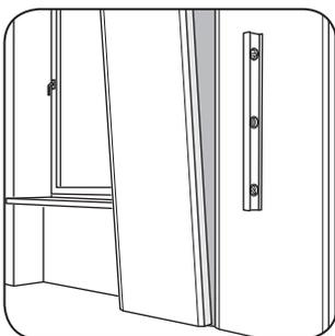
Les panneaux d'aménagement doivent être posés d'aplomb sur le mur. L'ajustement se fait par de légères pressions sur le panneau.
