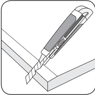
Les découpes se réalisent à l'aide d'un cutter ou d'une scie égoïne.
