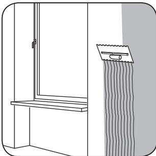
Réaliser un collage en plein avec un mortier colle à carrelage type C2s1 sur le support droit (redressé au besoin).
